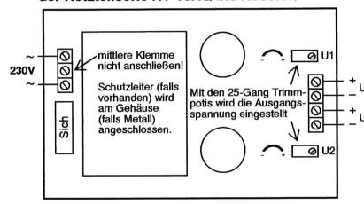
Die Netzteile besitzen zwei voneinander unabhängig einstellbare Ausgangsspannungen, die gemäß der geforderten Anwendung verschaltet werden können. z.B. Symmetrische Spannung, Einzelspannung, usw. (Siehe Seite zuvor). Tip zur Parallelschaltung:
